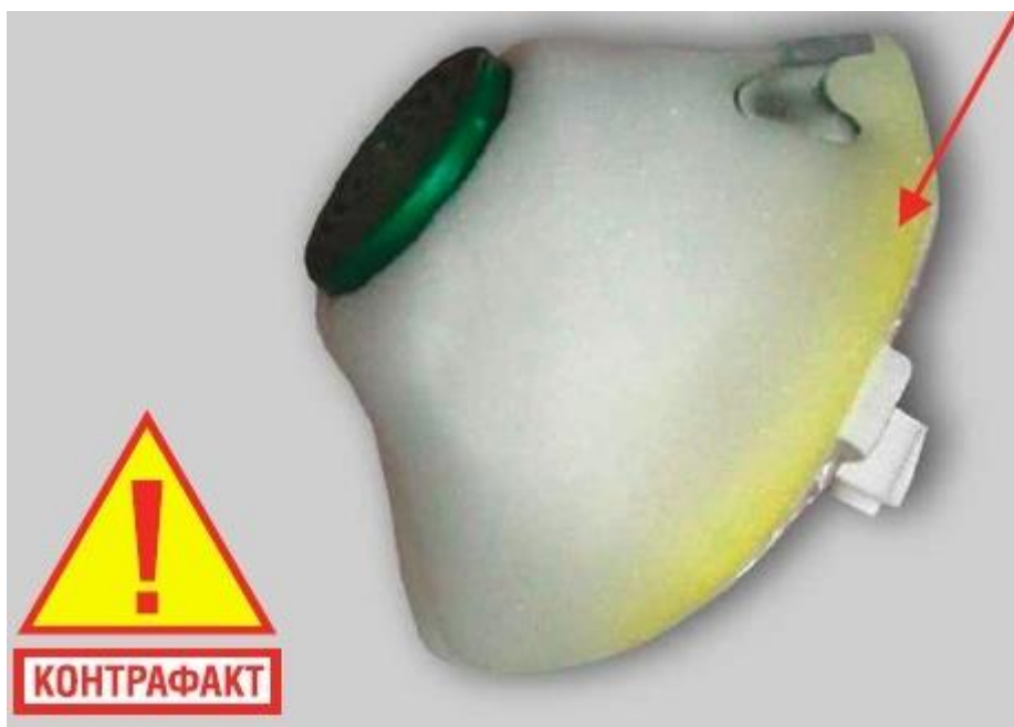
Рисунок 4.6. Пример фальсификации респиратора Р-2
