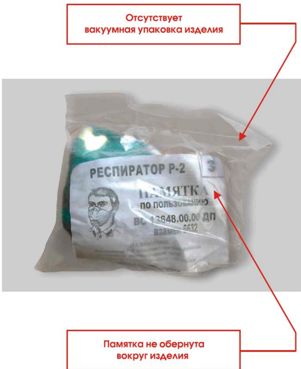
Рисунок 4.4. Пример фальсификации респиратора Р-2
